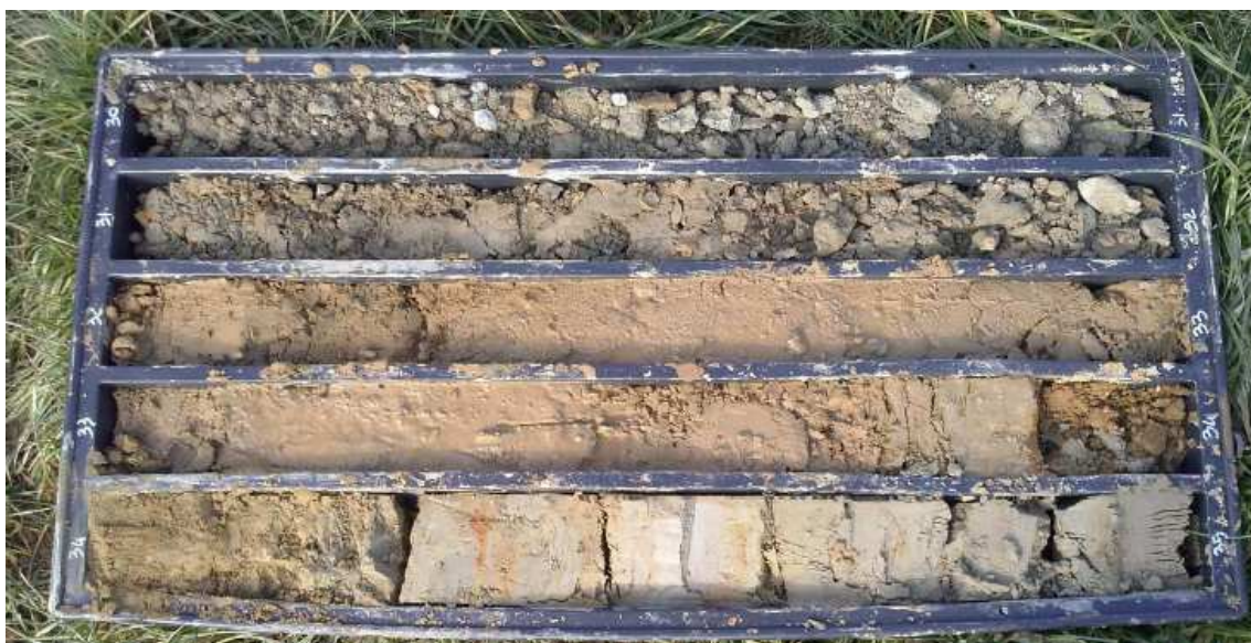
Fig. 7: S2 – cassa 7 (prof. 30-35 m. da p.c.): livelli di limi argillosi ed argilla
