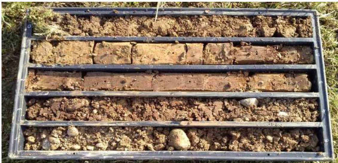
Fig. 9: S5 – cassa 1 (prof. 0-5 m. da p.c.): porzione superiore pedogenizzata con limi argillosi fino a 3 metri da p.c.
